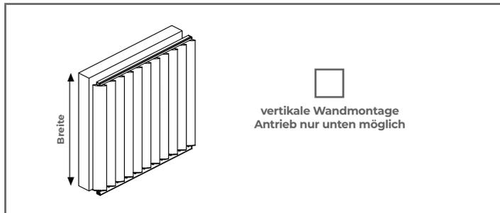
**Das System SUNBREAKER 210 kann in einer Nische oder auf einer Unterkonstruktion montiert werden. ES GIBT KEINE HALTER ZUR FASSADENMONTAGE!!!**
