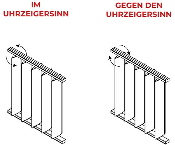
Man kann zwischen der Lamellendrehrichtung im Uhrzeigersinn oder gegen den Uhrzeigersinn wählen.
